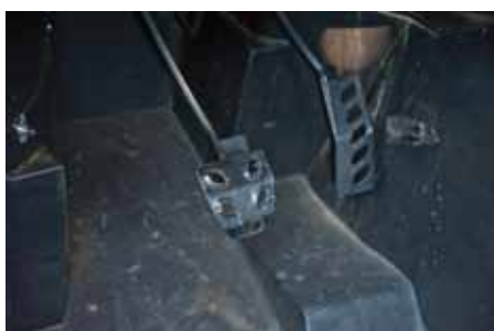
På SS är kopplingspedalen borta då det nu sköts automatiskt när man byter växel på paddlarna.
