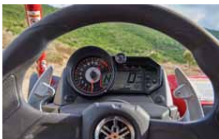
Den uppdaterade instrumenteringen har fått svart bakgrund och utrustats med programmerbar växelindikatorlampa samt lite nya symboler tillhörande växelsystemet YCC-S.
