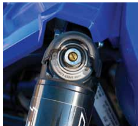
Även om det sitter snäppet värre dämpare på SE-modellen har man allt som går att önska redan på dessa fullt justerbara FOX 2.5 Podium RC2-dämpare.
